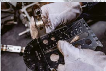
Быстрая проверка перпендикулярности измерительной ножки
